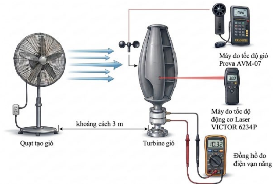
Hình 4. Sơ đồ bố trí thí nghiệm đo tốc độ gió, tốc độ quay và điện áp đầu ra của turbine gió
