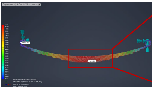
Hình 12. Kết quả mô phỏng chuyển vị và ứng suất của hệ thống treo nhíp lá ở mức tải 6.401 N
