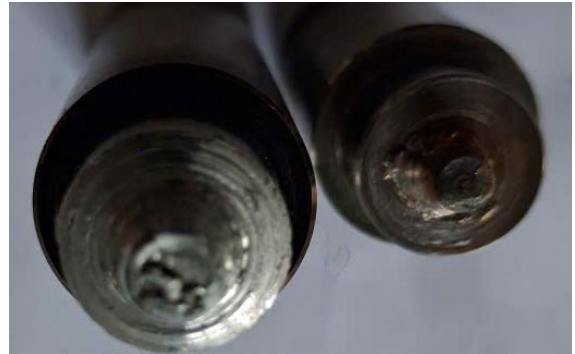
Hình 6. Đầu chày bị dính vật liệu hàn
