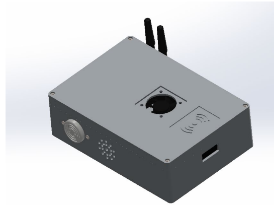
Hình 3. Mô phỏng của thiết kế vỏ hộp cảnh báo trên SOLIDWORKS
