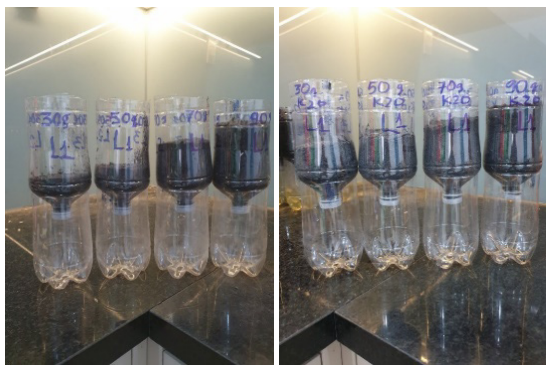
Hình 3. Sự hấp phụ khí lọc qua TSH cây sậy với phân khoáng N, P, K và NTH trong chăn nuôi
