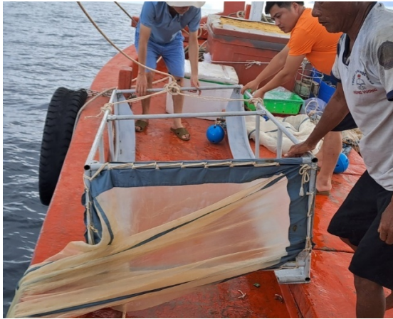
Hình 2. Thiết bị thu mẫu nguồn giống tôm tầng đáy
