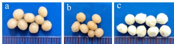
Hình 5. Hình chụp hạt alginate cố định vi khuẩn
