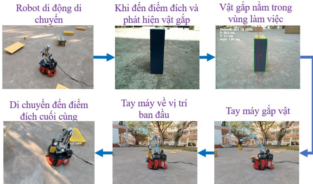
Hình 9. Quá trình robot di chuyển thực tế
