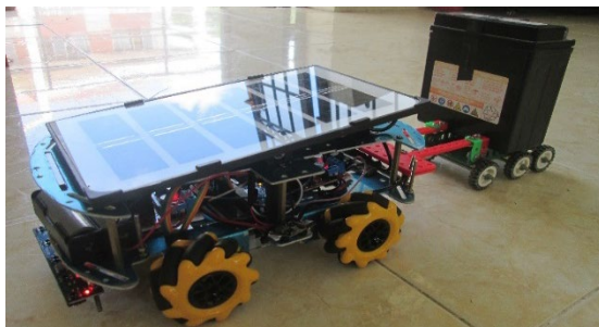
Hình 14. Thử nghiệm khả năng tải trọng
