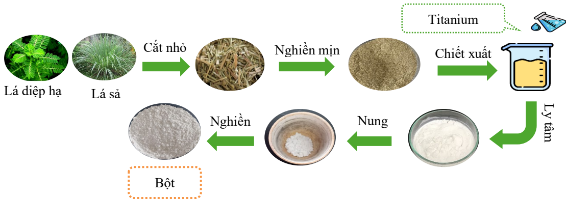
Hình 1. Quy trình tổng hợp nano TiO 2 từ chiết xuất lá Diệp hạ châu ( Phyllanthus urinaria ) và lá Sả ( Cymbopogon citratus )
