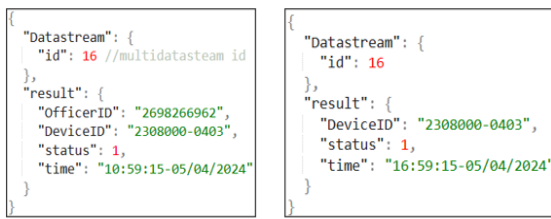
Hình 2. Định dạng dữ liệu thiết bị phần cứng gửi về máy chủ: (a) Quét thẻ xác thực bắt đầu sử dụng, (b) Quét thẻ xác thực kết thúc phiên sử dụng
