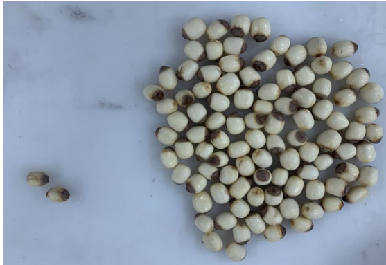
Hình 10. Hạt sen sau khi chạy máy với tốc độ quay của đĩa 2000 vòng/phút trong 6 phút
