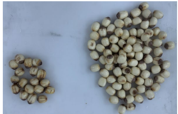
Hình 9. Hạt sen sau khi chạy máy với tốc độ quay của đĩa 1200 vòng/phút trong 6 phút
