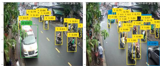
Hình 2. Kết quả phát hiện phương tiện với mô hình DETR
