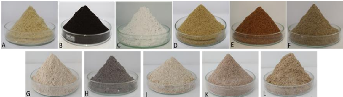
Hình 2. Các loại chất mang được sử dụng để tồn trữ vi khuẩn Comamonas sp. PAN1.12
