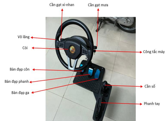
Hình 4. Bộ vô lăng VICTOR 1 (gồm có vô lăng, cần số, bàn đạp ly hợp, phanh)
