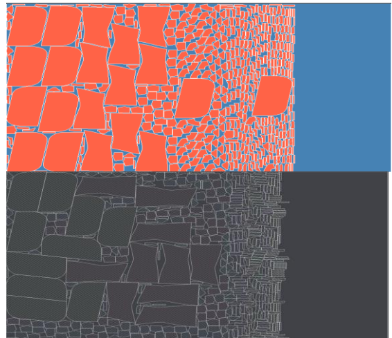
Hình 7. Sơ đồ cắt được tối ưu: (a) Sử dụng phần mềm thương mại NestFab (75.3%) và (b) sử dụng giải thuật NFP và GA trong công cụ Deepnest (73.91%)
