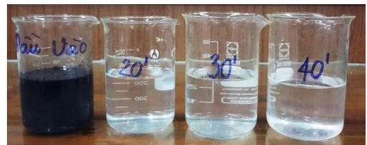
Hình 9. Biến động chất lượng nước xử lý với các TGLN khác nhau
