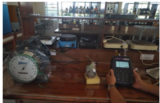
Hình 3. Đo đạc thể tích và thành phần khí
