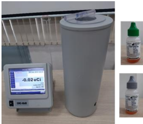
Hình 2. Thiết bị dose calibrator CRC-55t và hai nguồn tham chiếu Ba-133, Cs-137
